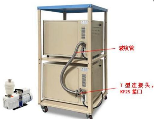
DZF-6050-II 是 2 台真空干燥箱，1 台双层移动架。此款设备可用于电池阴极片和阳极片干燥储存。
